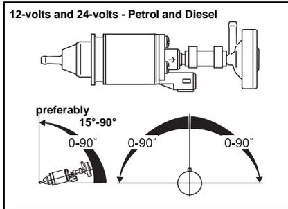
**Fig. 10: Metering Pump**
