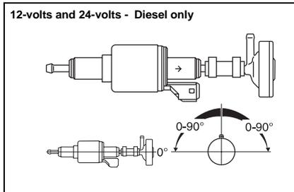
**Fig. 11: Metering Pump**
